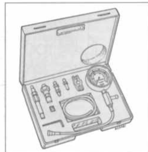
2.17 Dieseltune DX 511 compression tester
