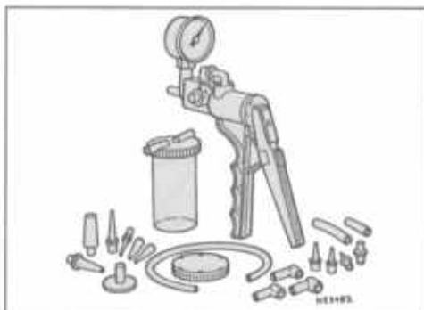
2.22 Dieseltune DX 760 'Mityvac' test kit
