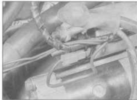
3.3B Starter motor solenoid wiring (Mitsubishi/Melco)
